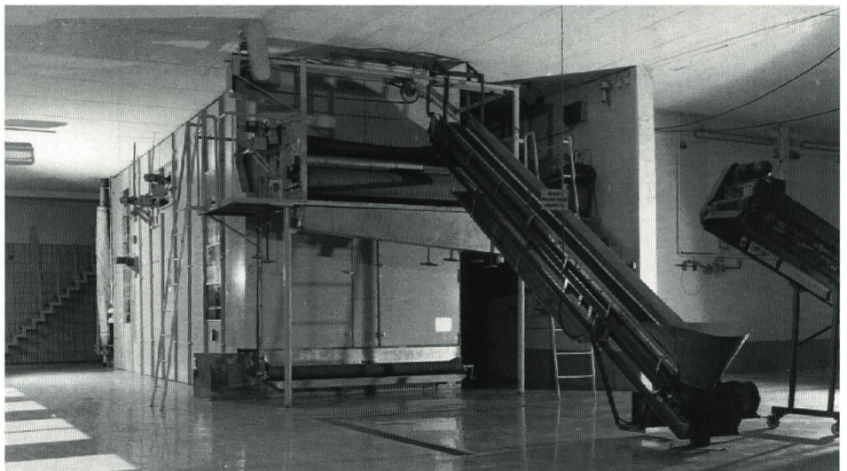
▼ Kräuter-Nachbearbeitungslinie: Aufgabeeinheit, Metallverlesung, Sichtertechnik, Rebler, Trieur, Taumelsieb
