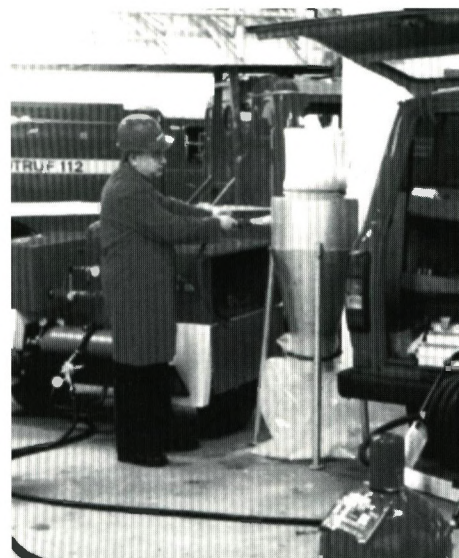
Die Werkstattwagen der Sachkundigen sind generell mit einer Pulver-Umfüllanlage sowie einer speziell entwickelten Prüfeinrichtung für druckbeaufschlagte Teile und Sicherheitsventile ausgestattet.
