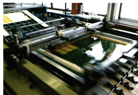
Herstellung von keramischen Abziehbildern mit vollautomatischer Siebdruckmaschine
